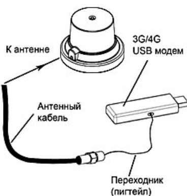
Подключите разъем кабеля антенны к вашему оборудованию. Для подключения антенного кабеля к модему, имеющему разъем отличный от SMA-female, потребуется переходник.
