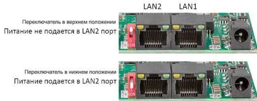
Слева от порта LAN2 размещен переключатель для подачи питания в порт. LAN2 порт может быть включен в режим PoE Out для выдачи питания на сетевое устройство (видеокамеру, роутер).
