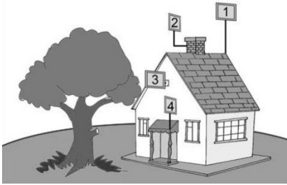
Рисунок 1 – Варианты установки антенны
