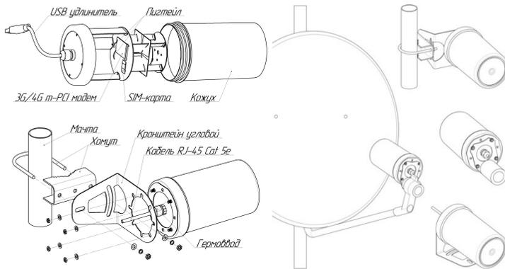
Отвинтите кожух антенны, вращая против часовой стрелки. Внутри, на задней крышке возле гермоввода, установлена компактная плата с разъёмом для подключения m-PCI-модема. Вставьте SIM-карту выбранного оператора сотовой связи в слот для подключения SIM-карты на плате.
