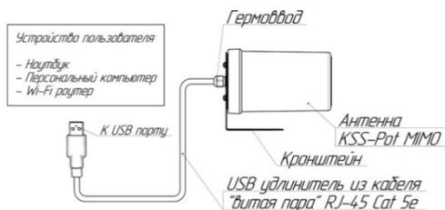
Подключите разъём USB-удлиителя к USB-порту вашего ПК. После включения и загрузки модема вы получите настроенное Интернет-соединение. Наведите антенну на базовую станцию. Если невозможно визуально определить расположение вышки или базовой станции оператора, необходимо отыскать место, в котором сигнал от базовой станции максимален.
