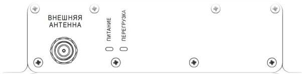
Рисунок 1 – Лицевая панель усилителя с LED-индикаторами
