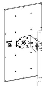
Рисунок 2 – Монтаж антенны на мачте
