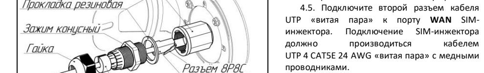
Схема 2 – Подключение UTP кабеля к гермоводу
