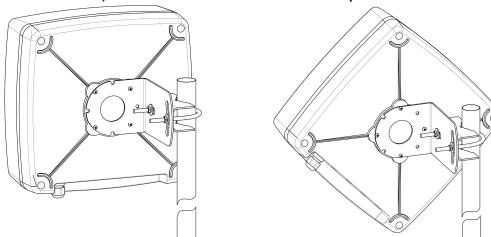
Рисунок 2 – Монтаж антенны
