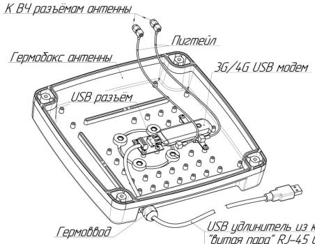
Схема 1 – Размещение 3G/4G USB модема в гермобоксе антенны и его подключение
