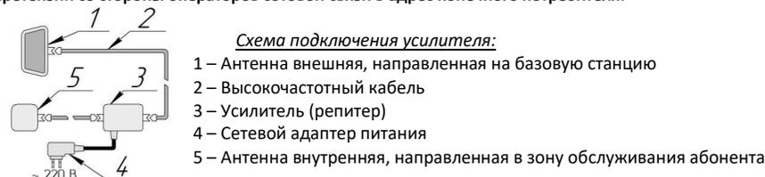
*Схема подключения усилителя:*
