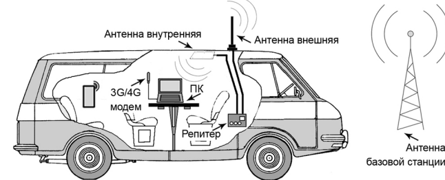
Схема 2 – Пример расположения антенны в салоне микроавтобуса при работе с репитером
