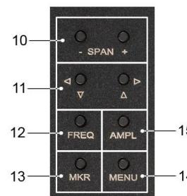
10. **SPAN** - (диапазон частот обзора) – кнопками «-» и «+» производится изменение диапазона частот обзора анализируемого сигнала.
