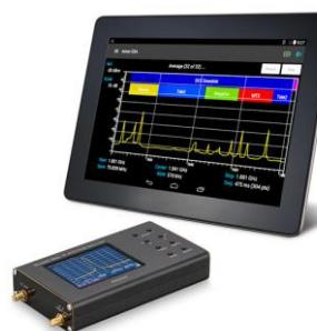
6.1. Анализатор спектра подключается в измеряемую цепь. На цветном сенсорном экране отображаются результаты измерений. Управление прибором производится кнопками управления и через экранное меню.
